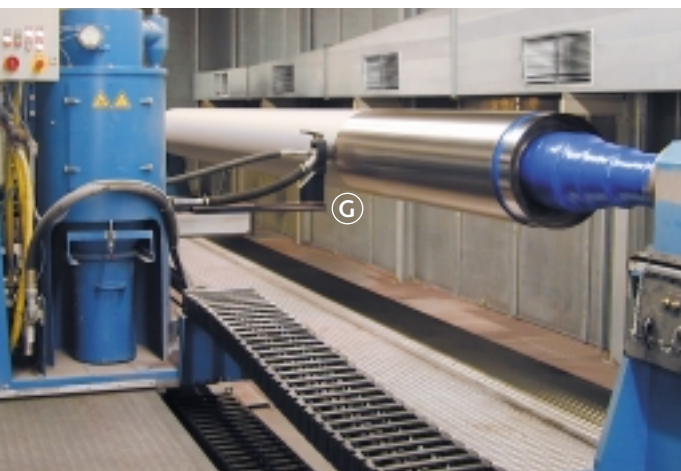
Automatisiertes Handling des Strahlkopfes beim Walzenstrahlen
